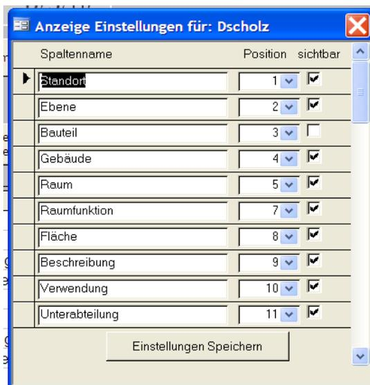
Die Anzeigeposition der Spalte im Datenblatt kann über die Combobox ausgewählt werden. Durch setzen bzw entfernen des Haken wird die Spalte angezeigt oder ausgeblendet.
